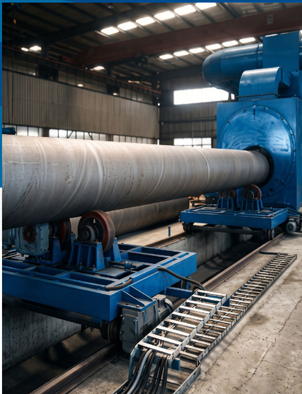
Дробеструйная обработка стальной трубы перед изоляцией
