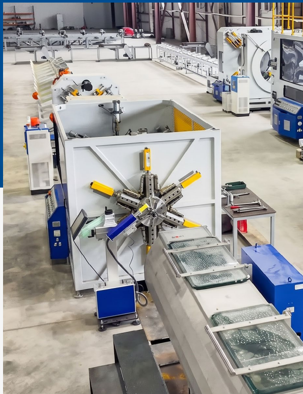
Собственное производство ПЭ-оболочки и заливка ППУ
